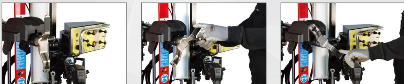
下部ビードブレーカーディスクを使ってのビード下部のディマウント作業
