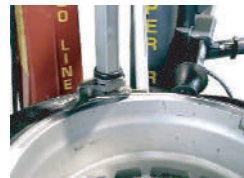
②タイヤレバーの挿入をサポートします。(RM1)
