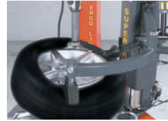
⑤タイヤ挿入時のサポートをします。
