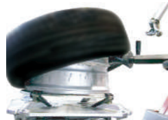
④ローラーを使ってタイヤが外せます。
