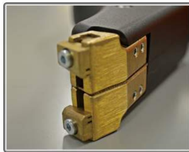
ブレード（専用替刃）取付ヘッド 付属の六角レンチを用いてブレード簡単取付
